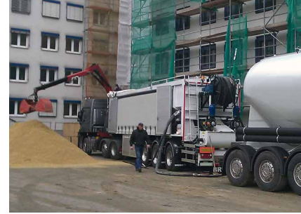
Durch das horizontale Produktionssystem kann die Anlage während des Herstellungsprozesses nachgeladen werden.
